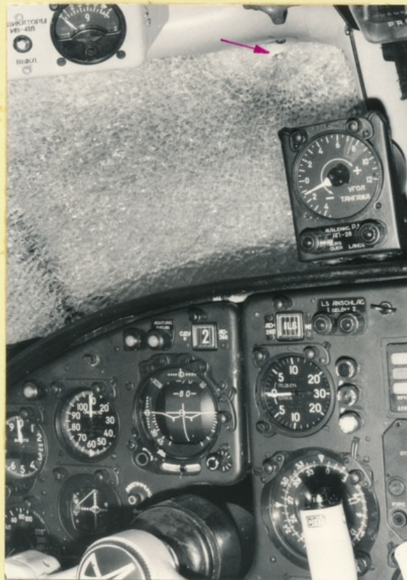
Bild 19 Nahaufnahme der durch Schußeinwirkung in kleine Kristalle gesprungenen Frontscheibe vor dem Kommandantensitz Pfeil - Projektilaufschlagstelle.
